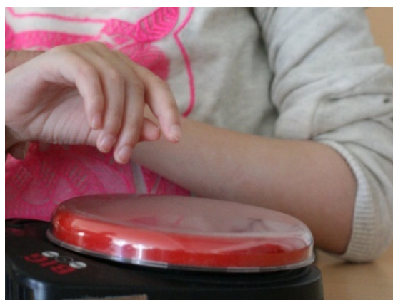
Abb. 24 Nutzung einer einfacher elektronischen Kommunikationshilfe, die auch als Taster zur Ansteuerung weiterer Geräte verwendet werden kann © M. Feichtinger
